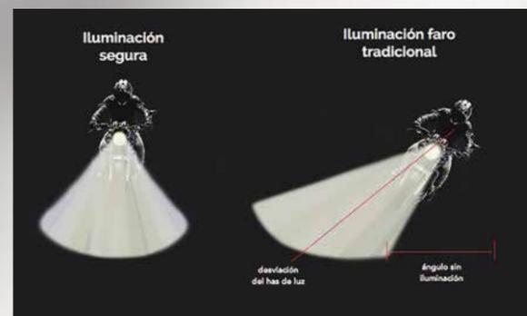
Con el Gyro Headlight se soluciona el problema de la desviación del haz de luz de los faros de motos cuando éstas se inclinan para tomar las curvas. Es un giroscopio electrónico que mantiene la iluminación sobre la calzada cuando la moto se mueve, sin importar el ángulo de inclinación, aumentando la seguridad en la conducción.
